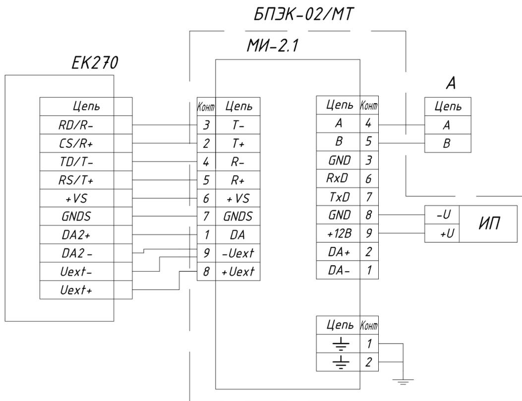
Рисунок 3. Схема внешних соединений БПЭК-02/МТ с корректором EK270 и внешним оборудованием по интерфейсу RS485, вариант исполнения без модуля функционального расширения.
