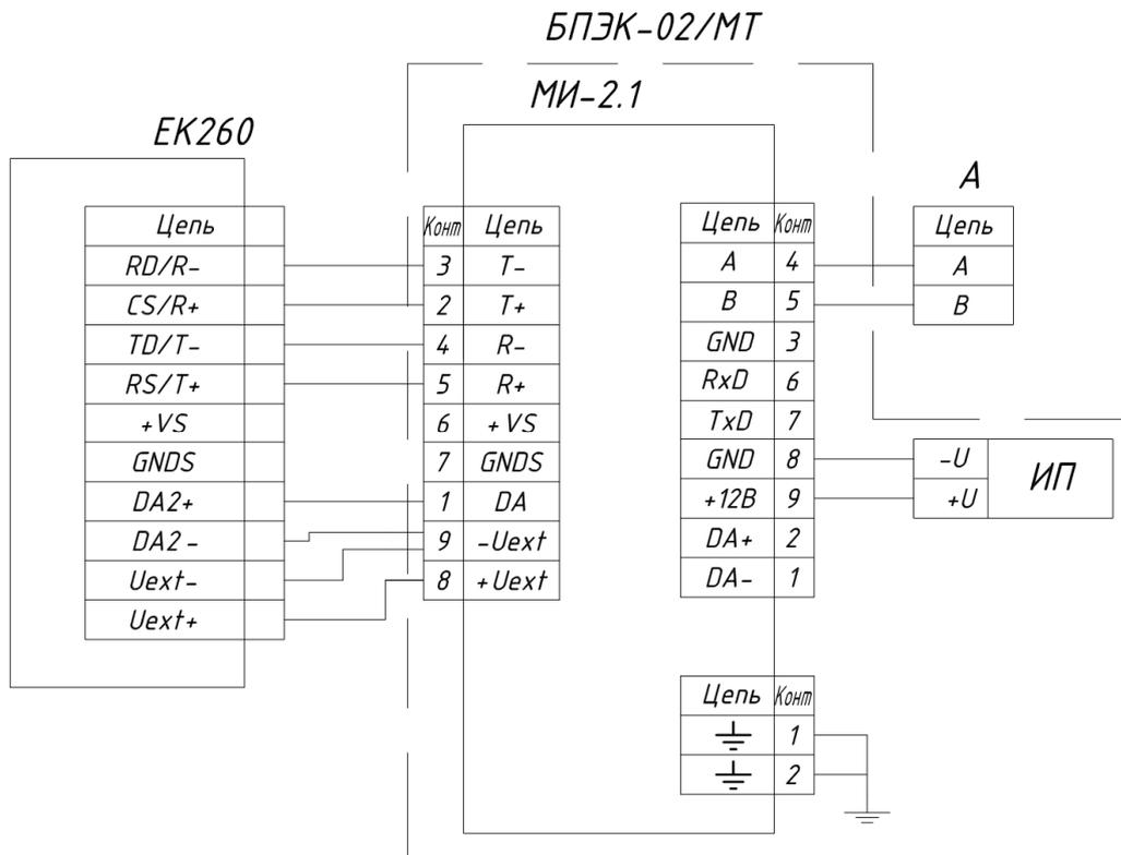
Рисунок 4. Схема внешних соединений БПЭК-02/МТ с корректором EK260 и внешним оборудованием по интерфейсу RS485, вариант исполнения без модуля функционального расширения.
