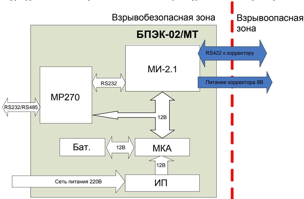
**Приложение В. Схема внешних соединений блока питания БПЭК-02/МТ**
