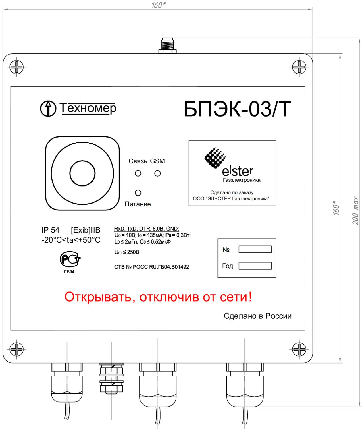
Рис. 1 Габаритные размеры блока питания БПЭК-03/Т исполнения 1
