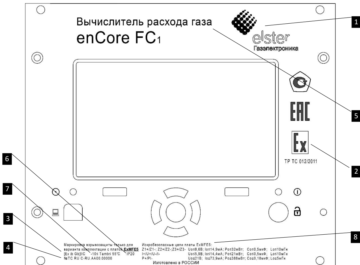
Рисунок 59 Маркировка взрывозащиты на передней панели вычислителя.
