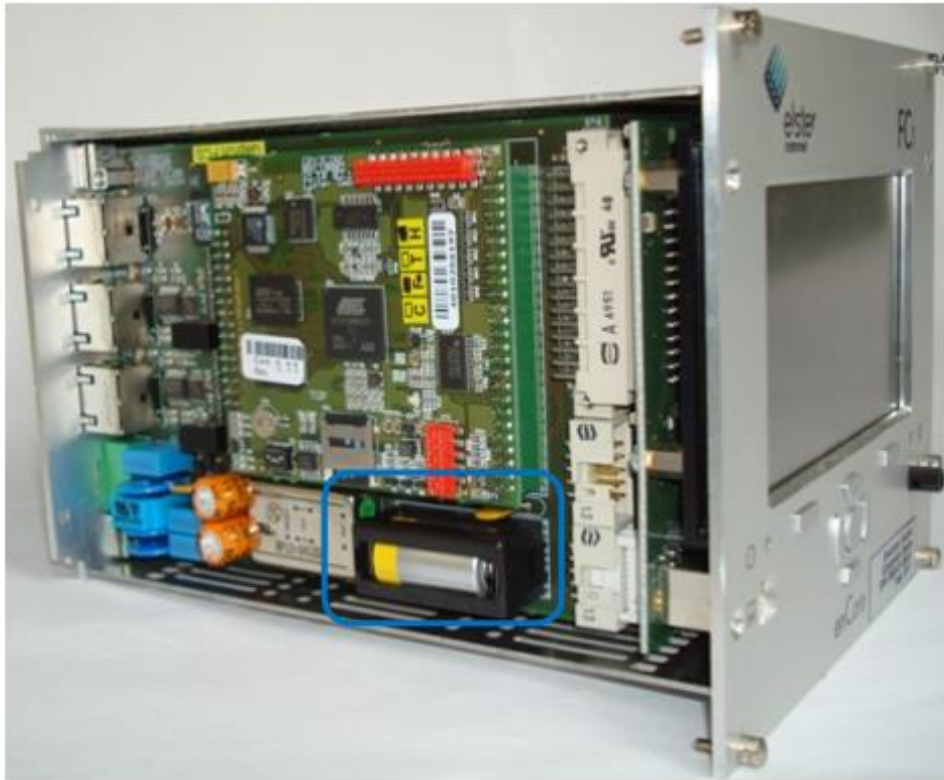
Рисунок 57 Расположение внутренней батареи питания вычислителя
