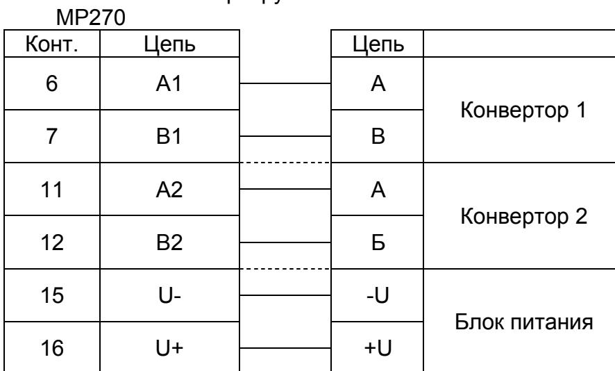
Для настройки интерфейса необходимо в меню настроек COM1 и/или COM2 указать тип соответствующего интерфейса RS232 или RS485 и скорость обмена. Рекомендуется устанавливать скорость обмена 19200. В случае большого количества ошибок при обмене с ПК необходимо снизить скорость обмена.
