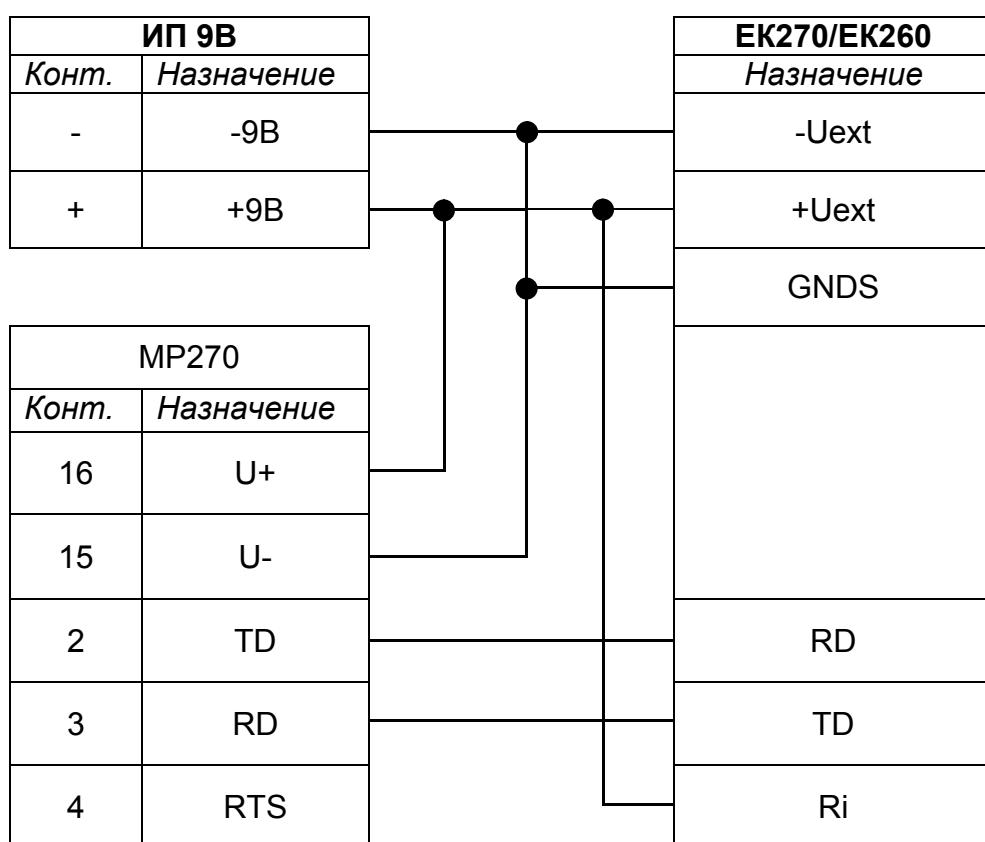
Длина соединительного кабеля между корректором и модулем не должна превышать 20 метров.
