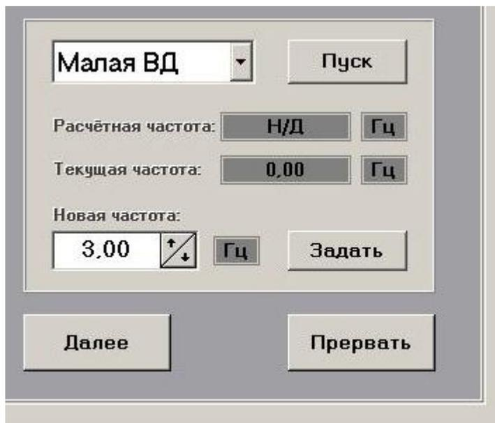
Рисунок 2 – Внешний вид поля управления преобразователями частоты.
