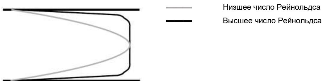
Рис. 5. Профиль потока в струевыпрямителе расходомера при больших и меньших числах Рейнольдса
