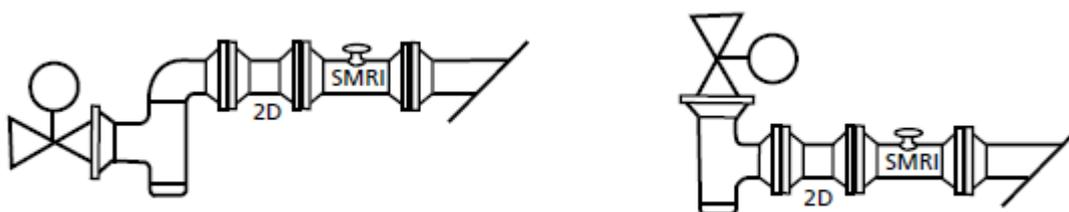
Рис. 6. Рекомендуемые способы установки регулятора в трубопроводе перед расходомером
