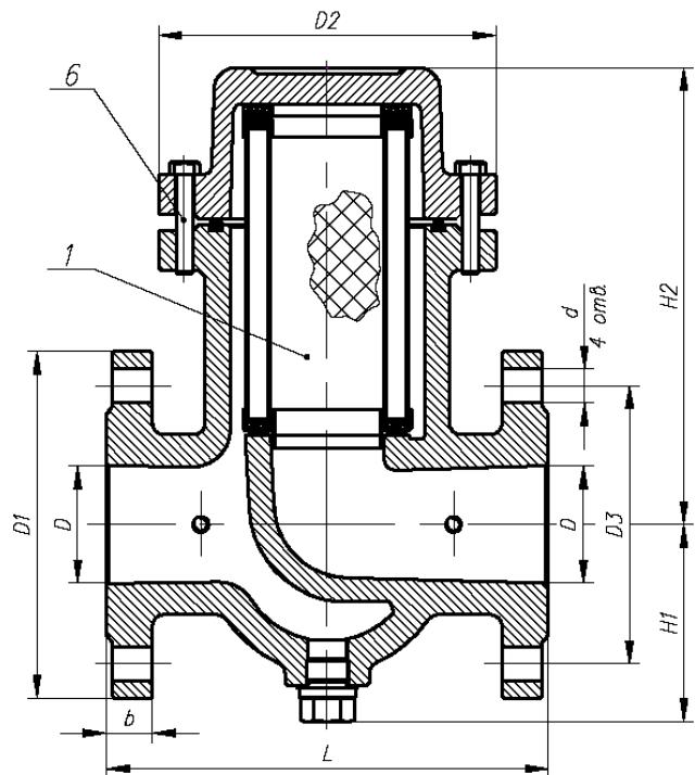
1 – фильтрующий элемент; 2 – крышка; 3 – корпус; 4 – пробка; 5 – заглушка; 6 – болт
