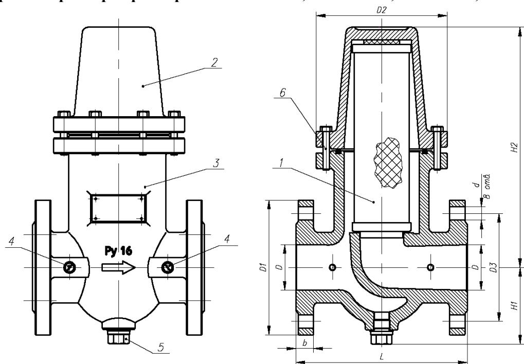
1 – фильтрующий элемент; 2 – крышка; 3 – корпус; 4 – пробка; 5 – заглушка; 6 – болт
